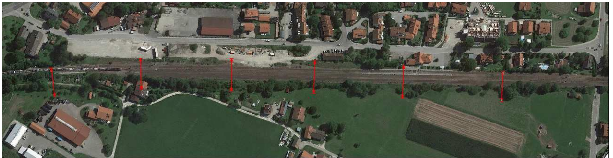
Trassenbreite des gemeinsamen Verkehrswegs im Bereich 4-gleisiger Bahnhof von 40 bis 45 m incl. Stützwände
