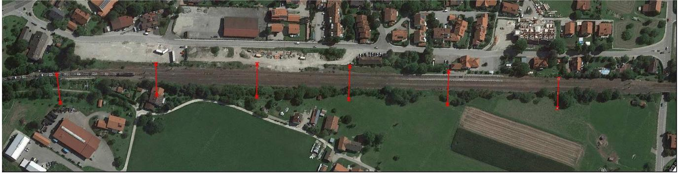
*Abb. 10: Trassenbreite des gemeinsamen Verkehrswegs im Bereich 4-gleisiger Bahnhof von 40 bis 45 m incl. Stützwände*
