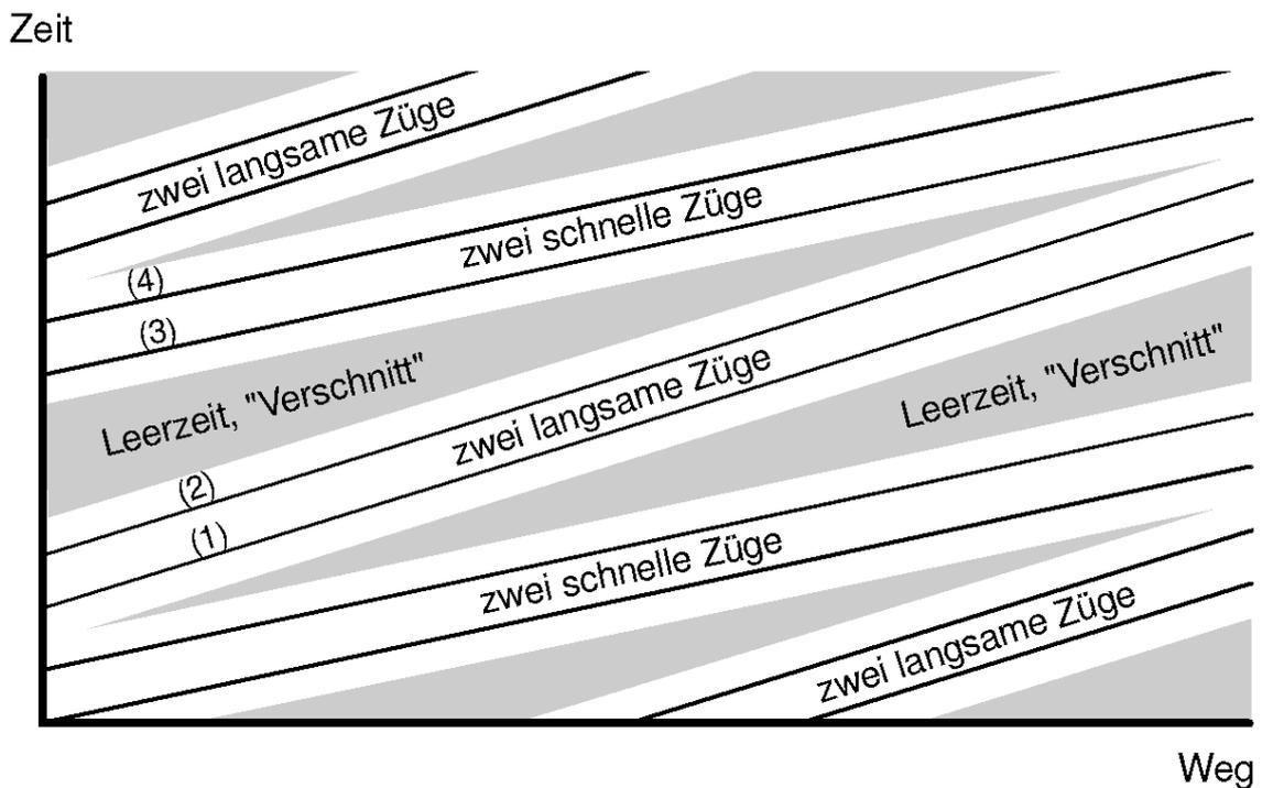
*Abb. 5: Beispielhafter Bildfahrplan mit unterschiedlichen Zuggeschwindigkeiten*
